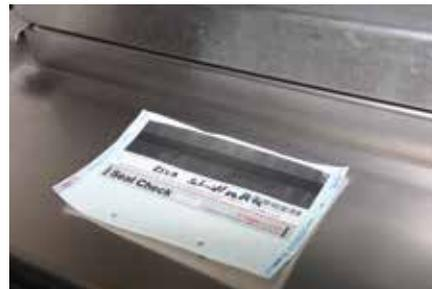
Seal-Check-Test: Funktionsbeurteilung der Siegelnaht
