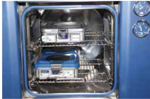
Dampf-Großsterilisator mit zwei Sterilisiereinheiten
