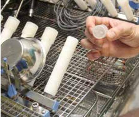
Verschiedene Anschlüsse für Hohlrauminstrumente
