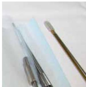
Schutzhülle am Instrument zum Schutz der Verpackung und der Siegelnaht
