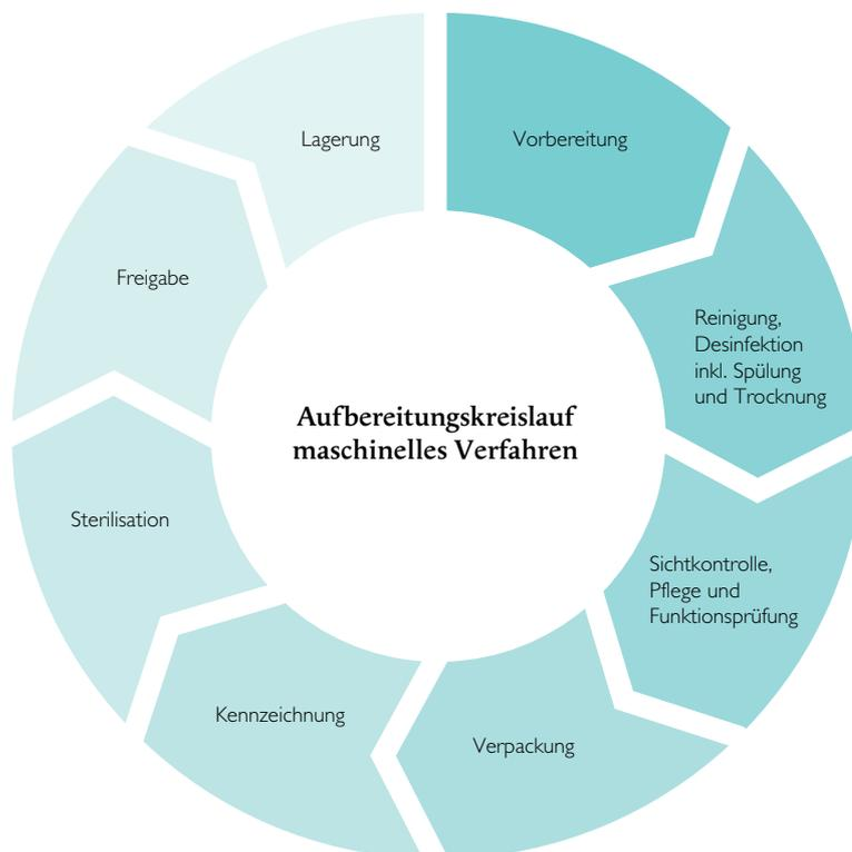
Abbildung 4: Aufbereitungskreislauf maschinelles Verfahren
