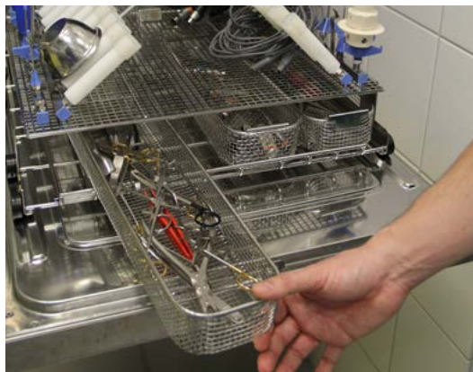
Bestücktes RDG mit Körben für Kleinteile
